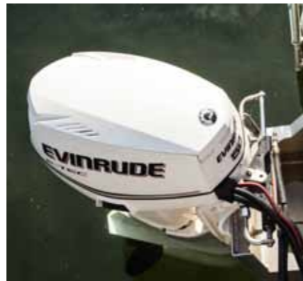
Moottorikaivo on korvattu moottoritelineellä eli bracketilla.
